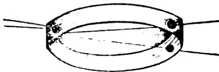
Les bouts de la corde ou ficelle seront passés à travers une capsule en étain et y seront fixés par un cachet à la cire. (Voir la figure ci-jointe). En outre seront à appliquer sur les bouts de l'emballage et sur les coutures, s'il y en a, des cachets en nombre suffisant et de manière qu'il ne puisse être porté aucune atteinte au contenu du paquet sans endommager extérieurement et visiblement l'emballage ou les cachets.
